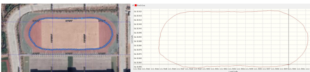
图 4-5 单兵 MEMS 系统绝对定位后的轨迹（加入重复修正）
