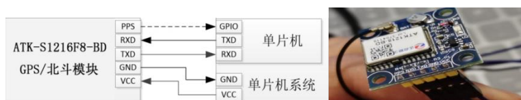
图 3-8 ATK-S1216F8-BD GPS/北斗模块与树莓派的连接实物图
