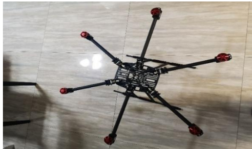
图11 无人机机架实物图
