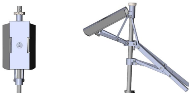
图 2.1.1 折叠式拐杖椅整体设计
