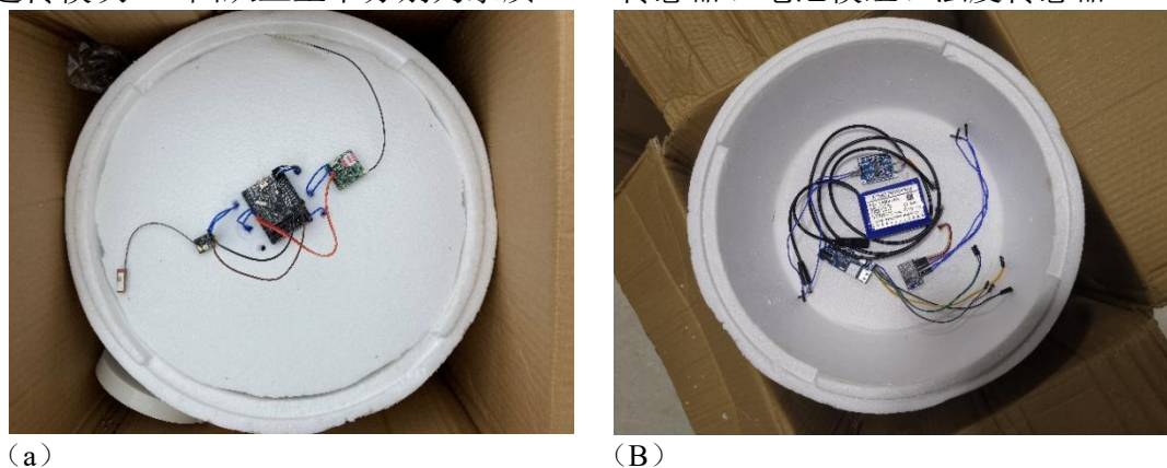
图 3 浮标数据采集系统测试模型实物图
