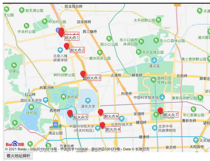
图 5-4 基于北斗定位的各监测点状态显示 点击着火地址解析按钮即可查询到着火地点的具体地址：
