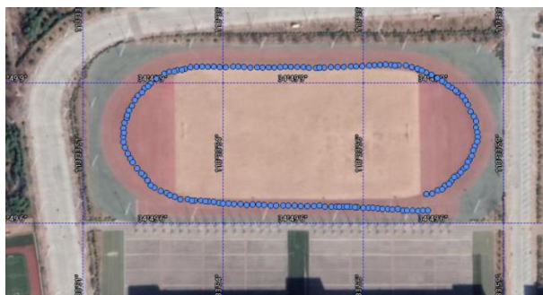
图 4-4 单兵 MEMS 系统绝对定位后的轨迹（未加入重复修正）
